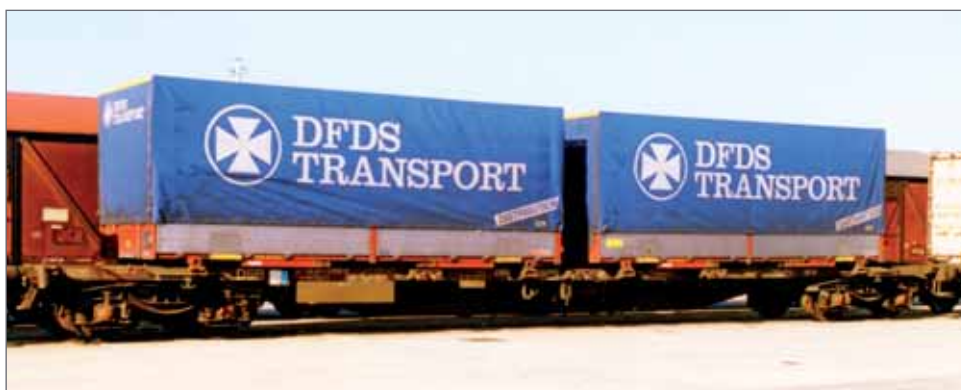
Carro Sgns danese caricato con due casse mobili telonate "DFDS TRANSPORT". Danish type Sgns container wagon loaded with two "DFDS TRANSPORT" swap bodies. Dänischer Sgns-Wagen, beladen mit zwei Planen-Wechselbehältern „DFDS TRANSPORT“.
