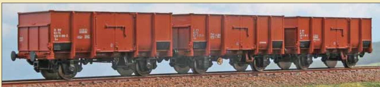
Set di tre carri merci FS Tipo Em con fondo di carico in metallo per carichi vari. Set of three FS freight wagons type Em with metal loading floor for various loads. Set aus drei FS-Güterwagen Typ Em mit Metallladeboden für verschiedene Ladungen.
