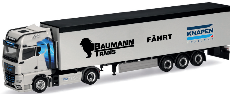
320085 MAN TGX GX Schubboden-Sattelzug "Baumann/Knapen" / walking-floor semitrailer (Baden-Württemberg/Laichingen)
